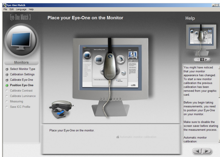
Pilt 18: Kolorimeetri asetamine monitorile.
