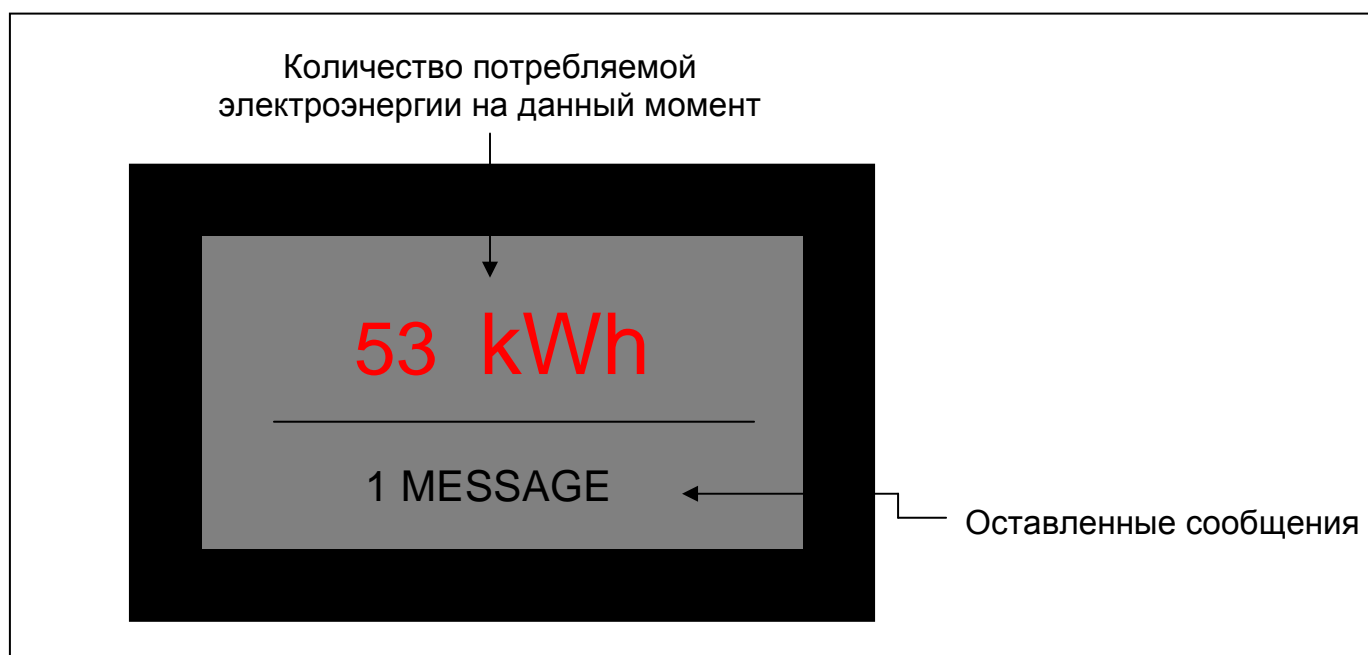
Рисунок 3. Визуализация дисплея Устройства для слежения за потреблением электроэнергии у бытовых приборов
