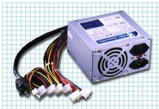
Pilt 39. LPX toiteplokk
