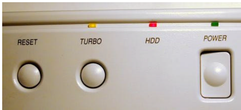
Pilt 1. Korpuse esipaneelil asuvad lülitid ja indikaatorid
