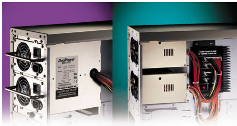
Pilt 34. Dupleeritud toiteplokk korpuses
