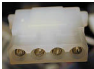
Pilt 33. Kõvaketaste jt. seadmete toitepistik
