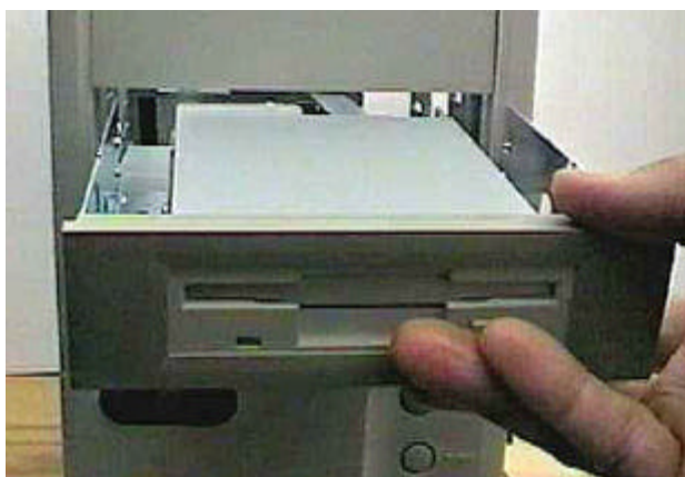
Pilt 8. Abiraam 3,5" seadme monteerimiseks 5,25" kettalahtrisse
