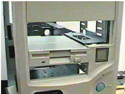
Pilt 5. 5,25" ja 3,5" väline kettalahter
