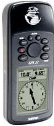
Joonis 7. Kaasaskantav vastuvõtja Garmin GPS 72
