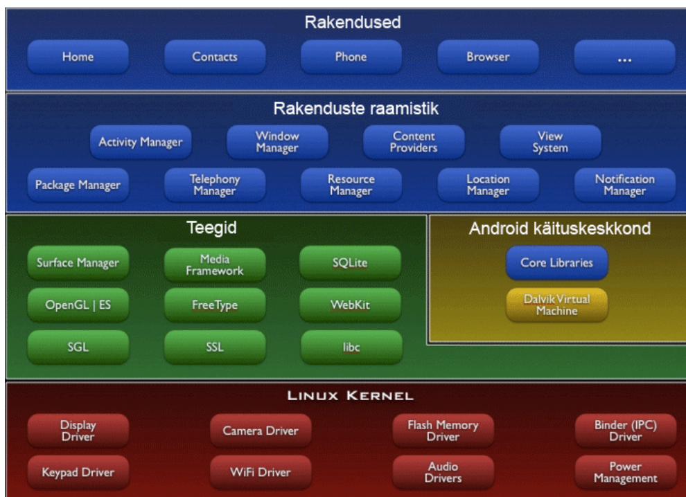
Joonis 1. Android'i ülesehitus. See diagramm näitab Androidi operatsioonisüsteemi tähtsamaid komponente.
