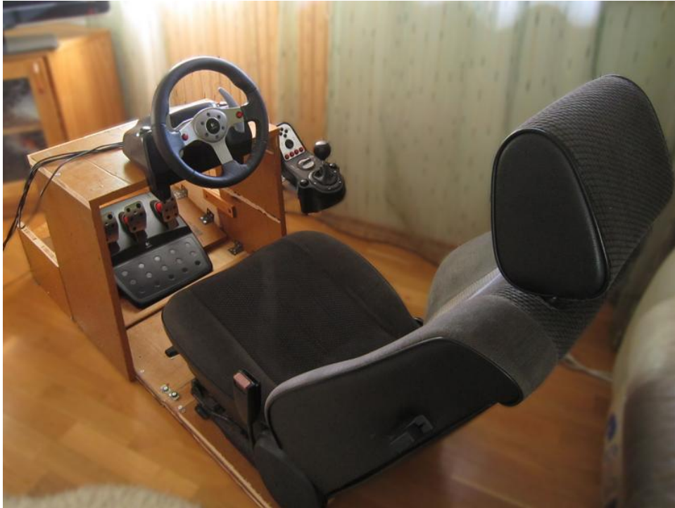
Joonis 3. Autori valmistatud konstruktsioon Logitech G25 roolikomplektille. Autori joonis.
