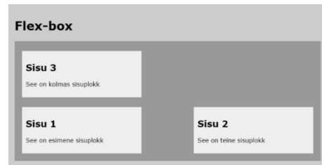
Joonis 86 Flex elemendid ei mahu reale, toimub ridade murdmine tagurpidi järjestuses ( wrap-reverse )
