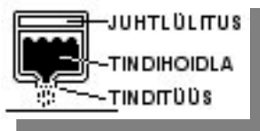
Joonis 27: Tindiprinteri printimispea.
