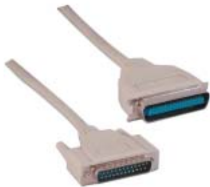
Joonis 31: Centronics rööpühenduskaabel. Vasakul arvutipoolne- ja paremal printeripoolne ots.
